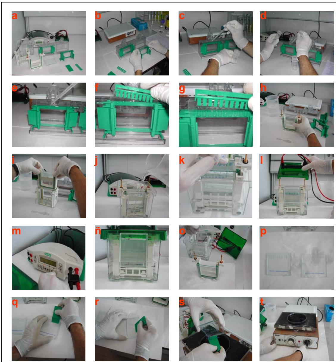
Figura 4. Desarrollo de la práctica. Material de electroforesis vertical (a); montaje del sistema (b); Preparación del gel separador (c,d) y concentrador (e-g); electroforesis (h-ñ); tinción del gel (o-s)
